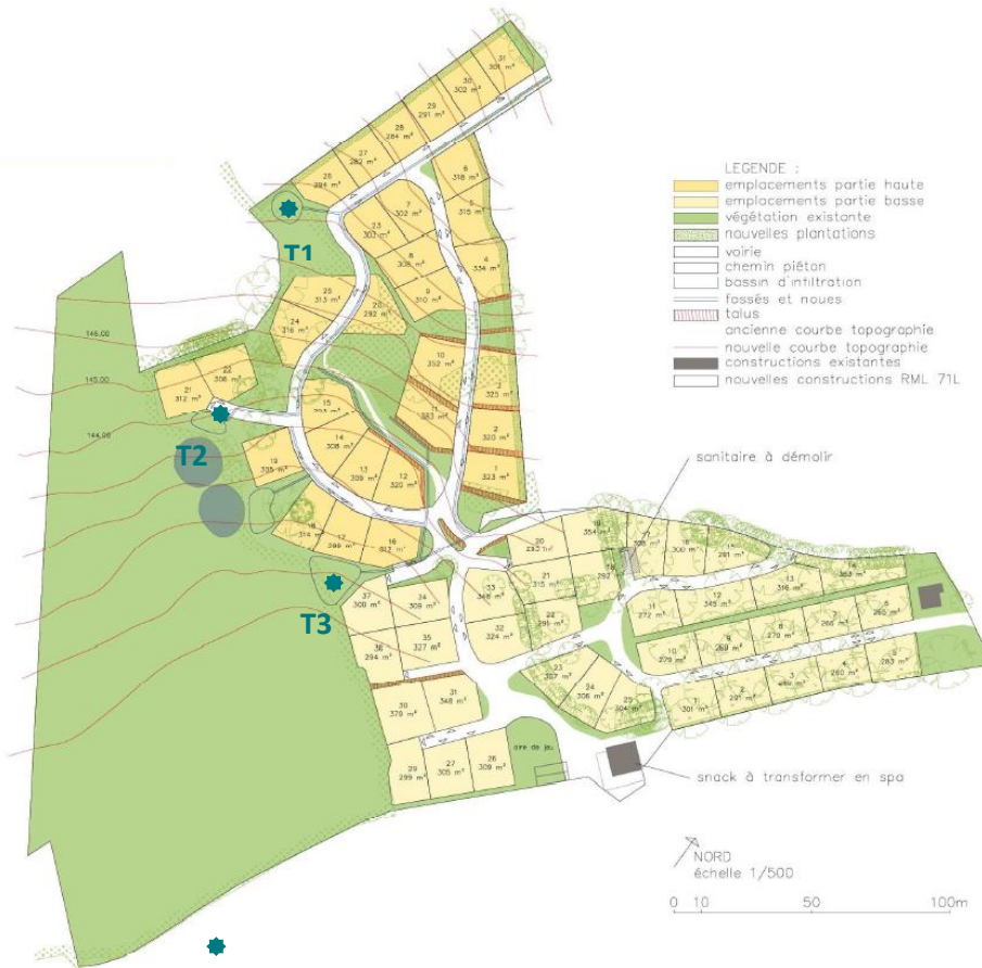
Figure 1 – Localisation des tests de perméabilité
