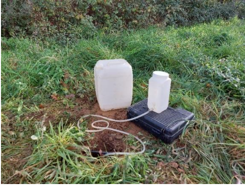
Photo 1 – Vue de l'essai de perméabilité d'un sondage (T1) après saturation prolongée.
