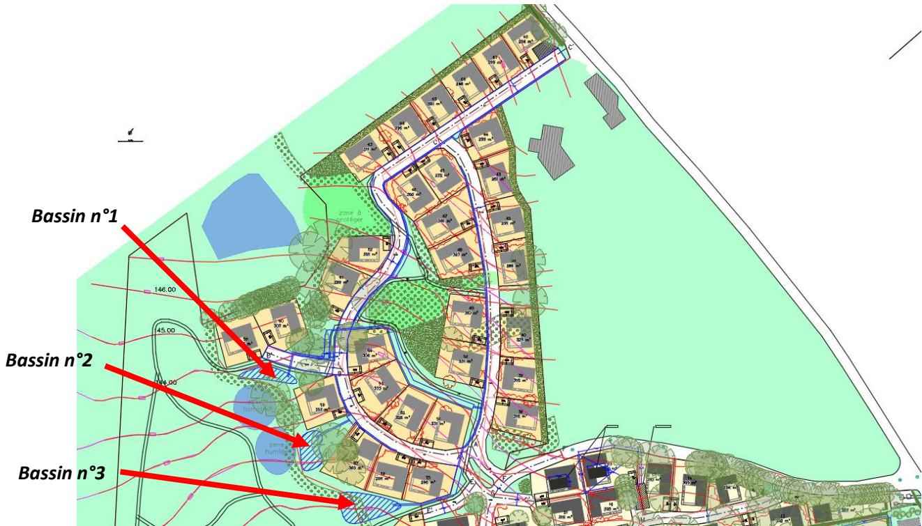
Position des bassins de rétention / infiltration suivant plan masse du permis d'aménager
