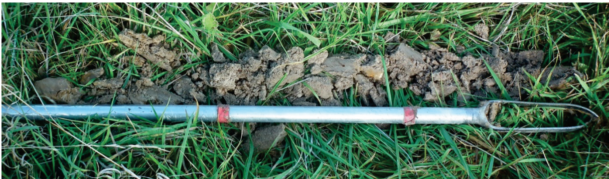
Figure 7 : Sol hydromorphe de type Vb, longueur 80 cm. Sondage n°1
