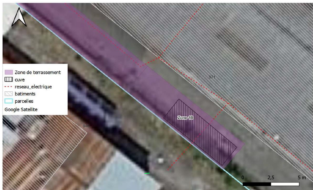
Figure 4 : Position du réseau électrique HT au niveau de la Zone 1 (source : rapport ORTEC n°9MO5223 de janvier 2023)
