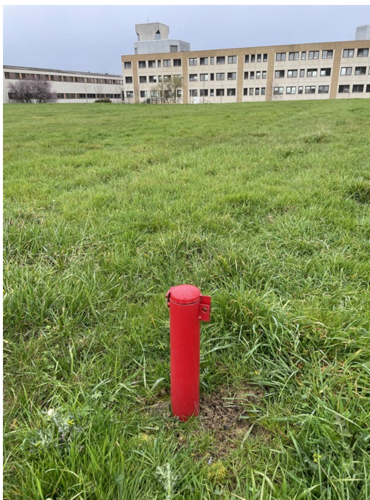
Aperçu du piézomètre PZ2 au niveau de la zone d'étude
