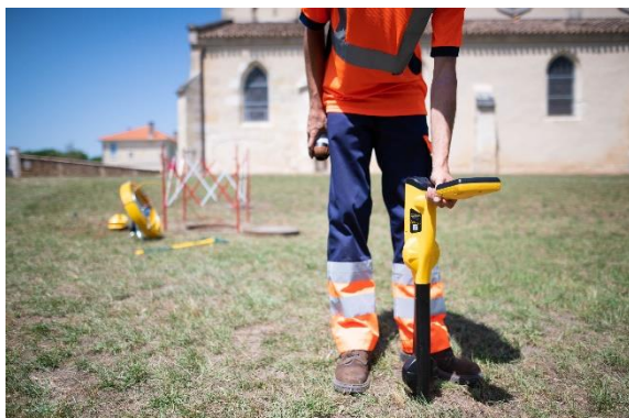
Figure 1 : Détecteur électromagnétique Vivax vLocPro3
