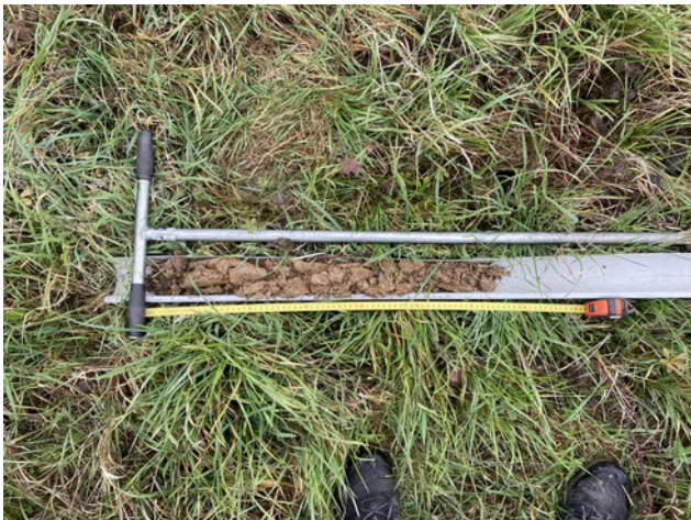
Sondage 1076 : Antroposol sur remblais avec refus (impossibilité de sonder) à partir de 60 cm
