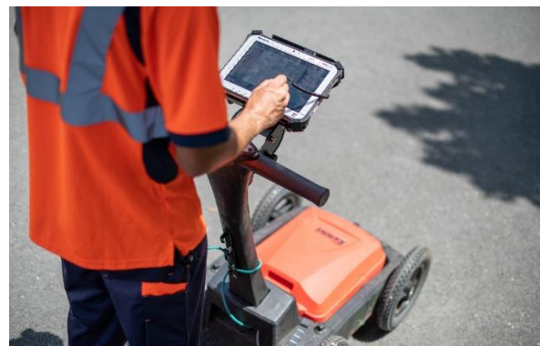
Figure 2 : Géoradar GSSI DF 300-800
