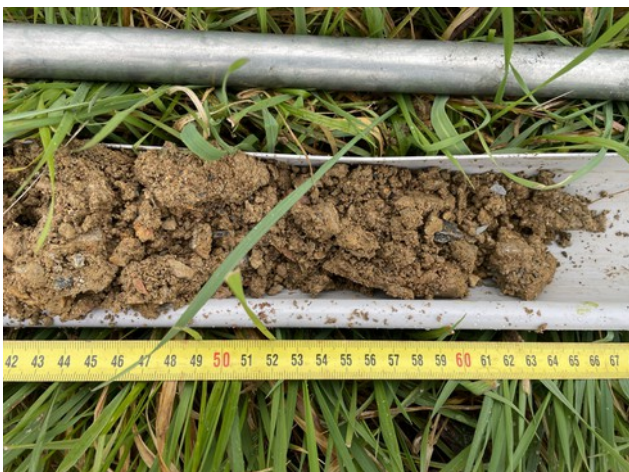
Sondage 1073 : Remblais, bloqué à 60 cm
