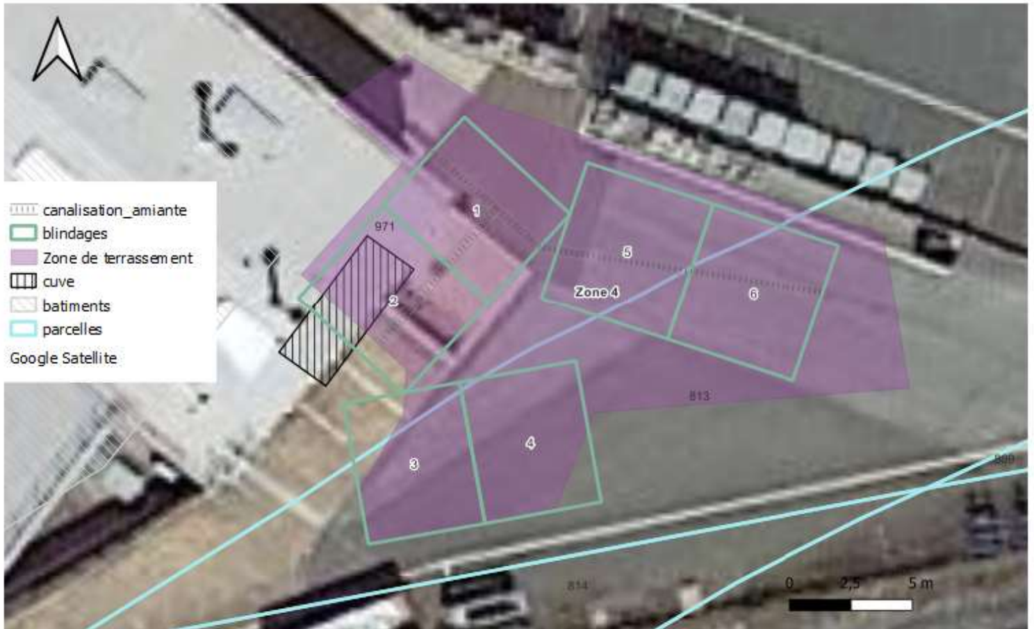
Figure 11 - Localisation de la conduite contenant de l'amiante sur la zone 4
