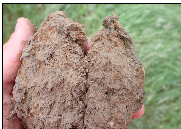
Figure 19 : Zoom sur le sondage n°5 caractéristique de zones humides (traits rédoxiques à partir de 20 cm)
