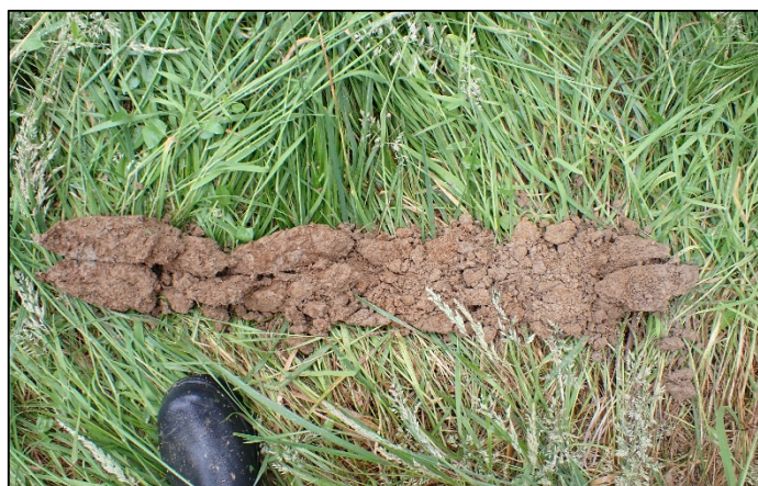
Figure 18 : Sondage n°5 caractéristique de zones humides (traces d'oxydation avant 25 cm et s'accroissant en profondeur)
