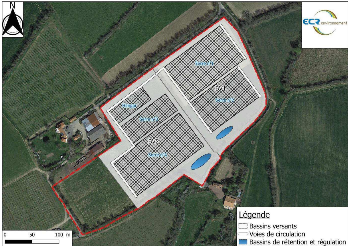
Figure 4 : Sous-bassins versants des eaux pluviales du site.
