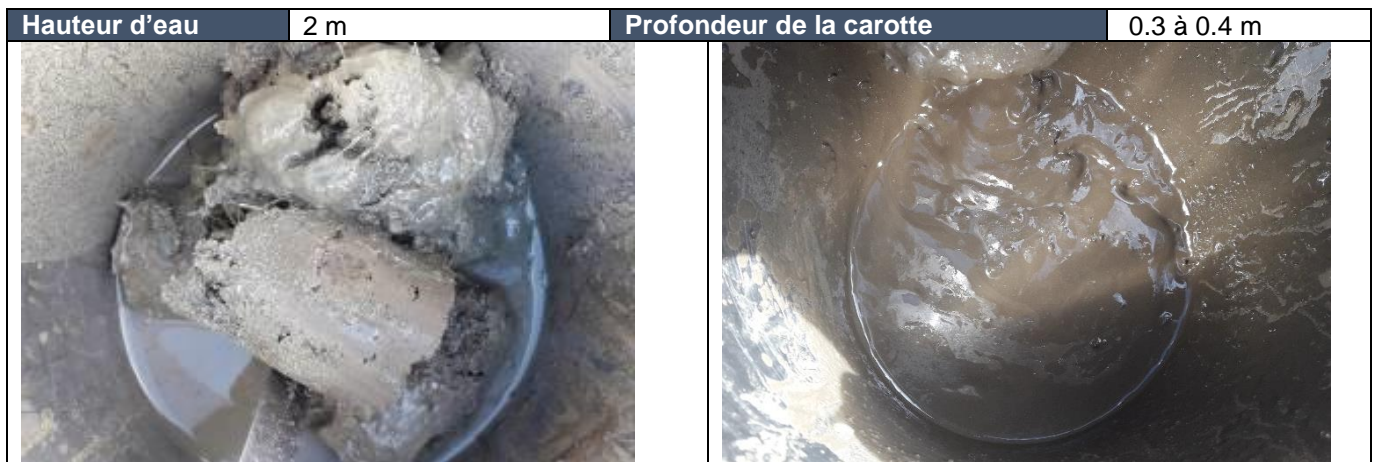
Figure 141 : Aspect des sédiments prélevés dans la retenue de Coiselet – coté Ain, rive droite
