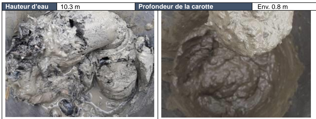
Figure 139 : Aspect des sédiments prélevés dans la retenue de Coiselet – coté Bienne
