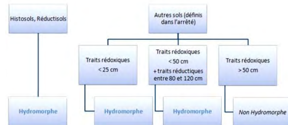
Figure 9 : Principe de détermination d'un sol hydromorphe de zone humide selon la réglementation.
