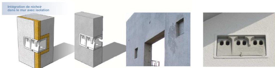
Possibilités d'intégration d'un nichoir au sein de la structure du bâtiment (source : Nature - Harmonie)
