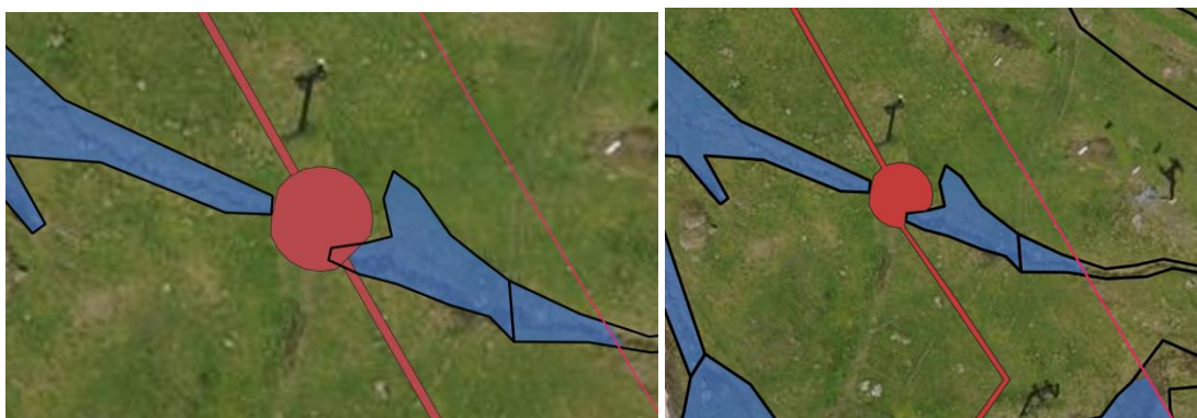
Limitation de l'emprise de terrassement autour du P5 KARUM
