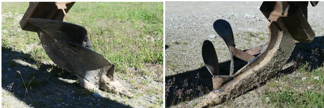
Bras de type charrue installé sur une pelle araignée_ KARUM
