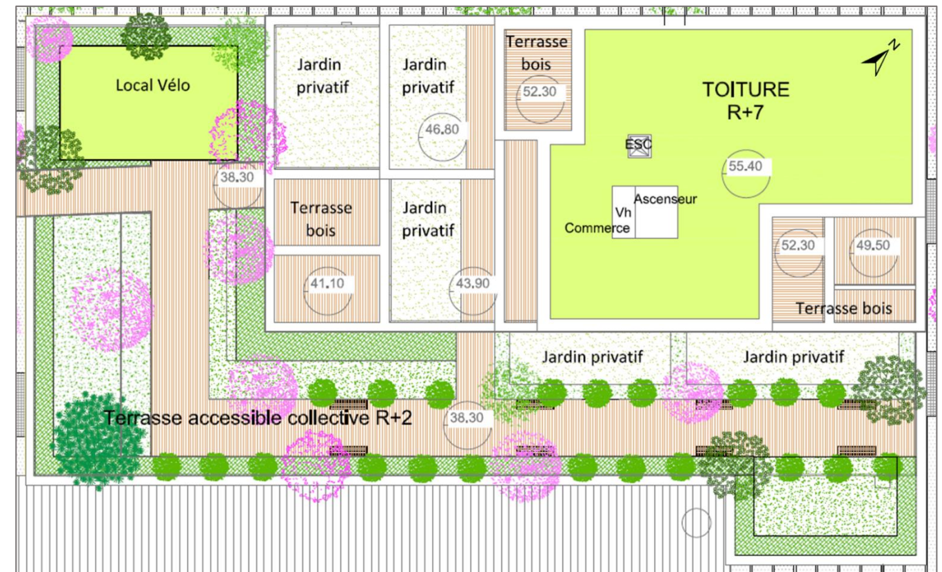
Figure 50 - Végétalisation de la toiture au niveau du bloc B
