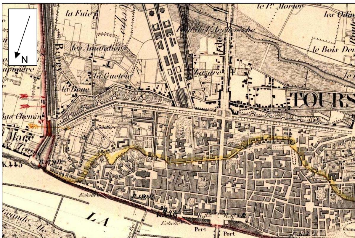
*Figure 3 : extrait de la carte de 1850 sur Tours sur lequel on voit les contours des inondations de 1856 (en trait continu jaune) et de 1866 (en trait continu rouge). A gauche de l'image, la flèche jaune coupant le canal correspond à la rupture de la gare du canal, et celles s'appuyant sur la digue, aux infiltrations dans la digue (présentation non conventionnelle, le Nord est dans le coin inférieur gauche de la carte)*
