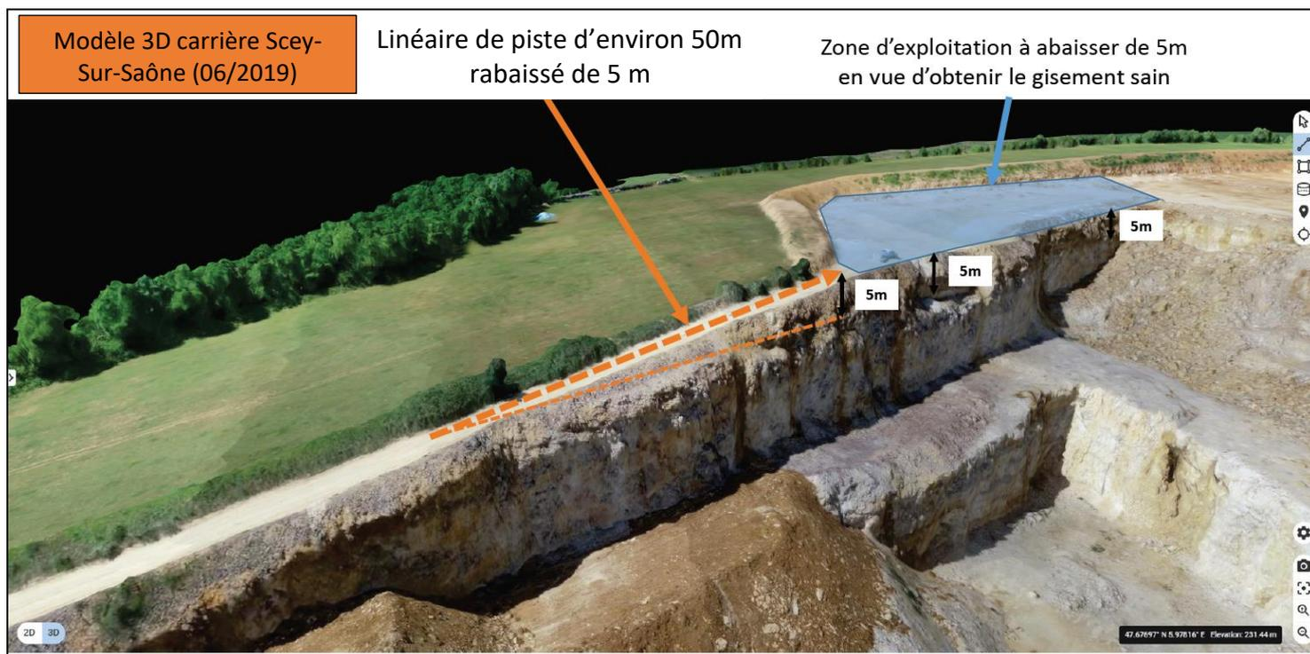
Figure 2 Travaux ayant été réalisés sur la piste à l'Est de la carrière de Scey-Sur-Saône (modèle 3D anté-travaux du 06/2019)
