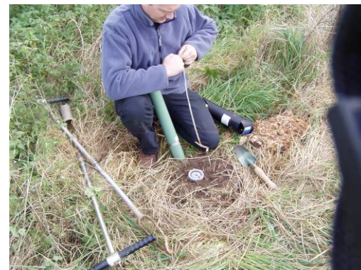
Installation d'une sonde «BARASOL »
