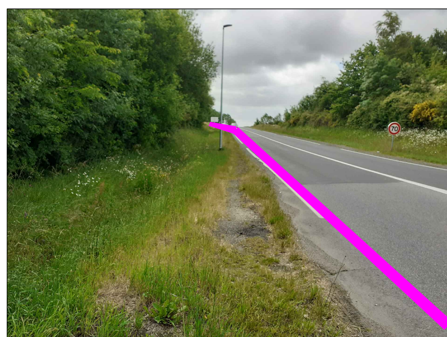
28. Après Giratoire Sèvre et Maine : présence réseau éclairage public. Pose réseau sous bord de chaussée Ou tracé alternatif à travers la parcelle boisée avant le giratoire
