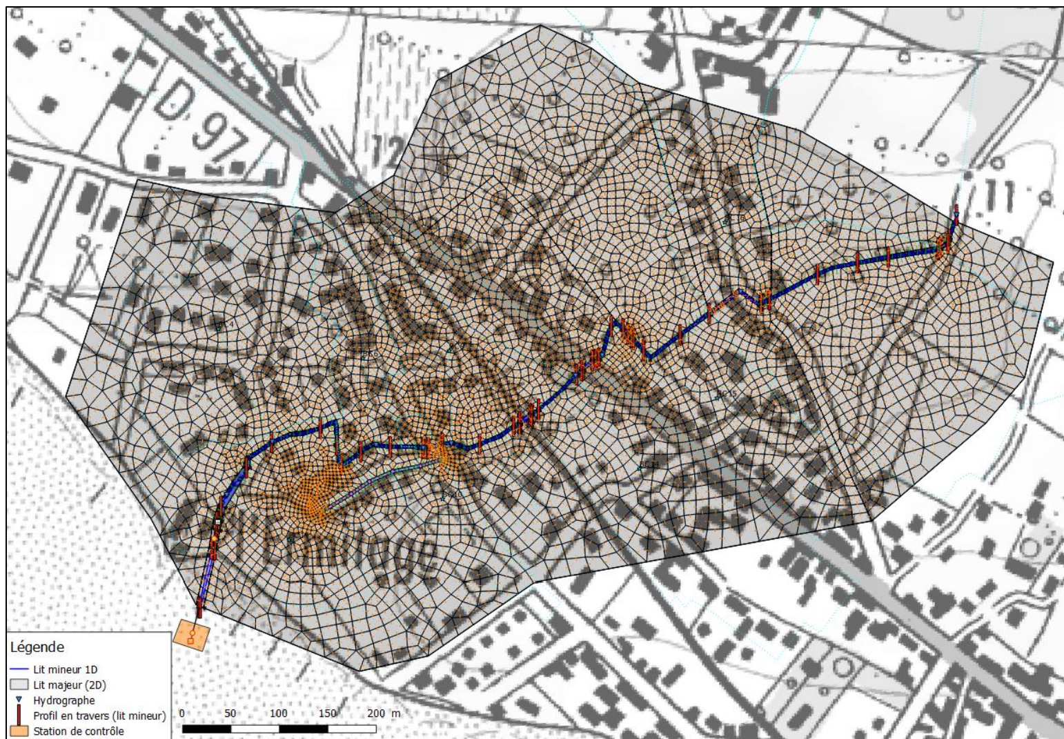
Figure 30 : Modèle 1D/2D du cours d'eau du Pontreau
