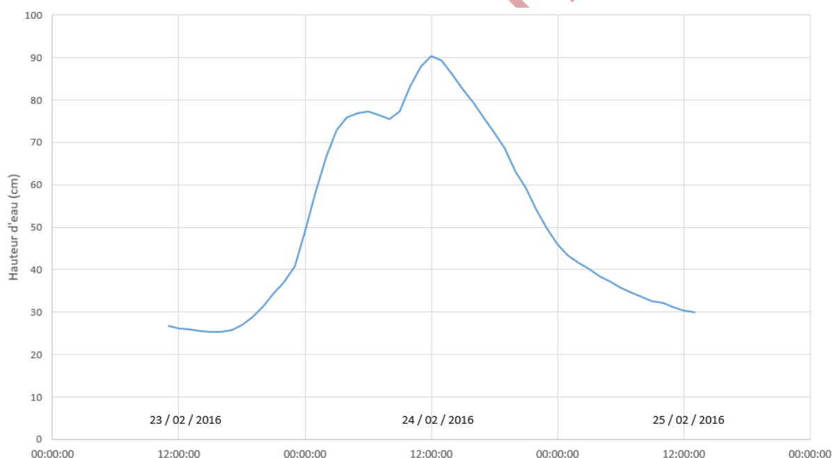
Figure 10 : Hydrogramme de la station de jaugeage entre le 23 et 25 décembre 2016
