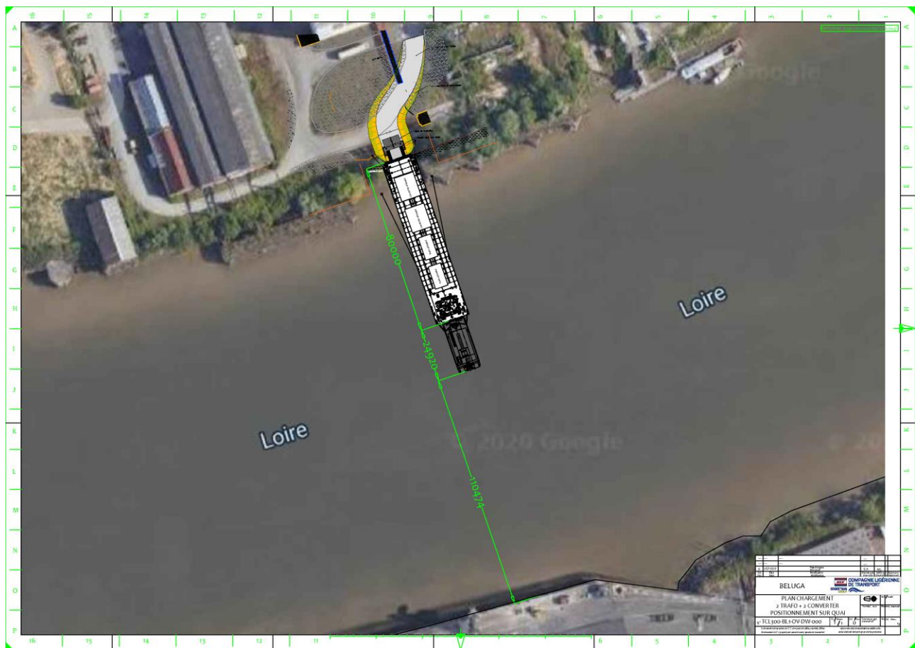
Principe de chargement des modules – Positionnement de la barge sur le quai
