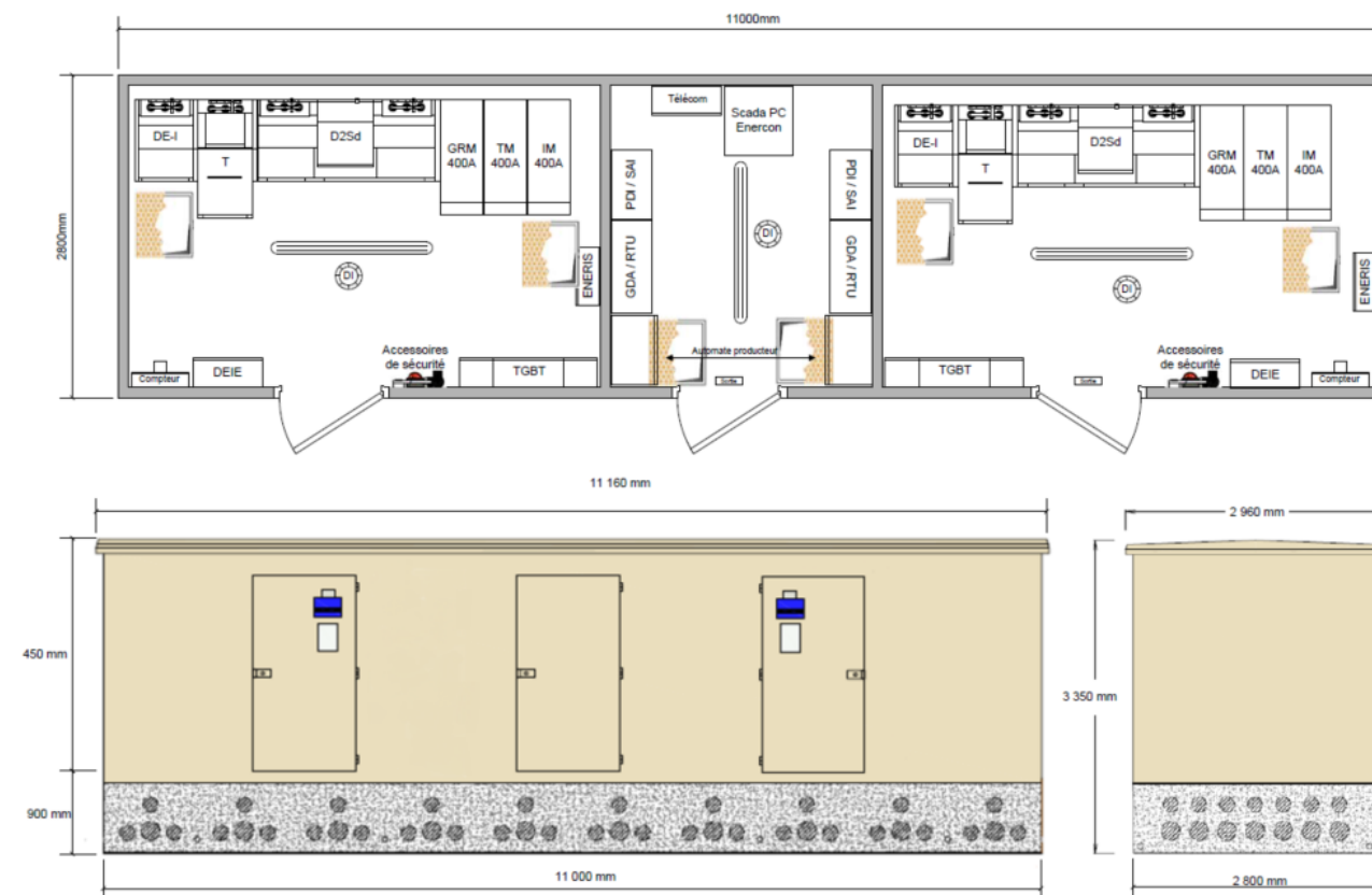
Figure 8 : Schéma d'un poste double de livraison (source : Laurent Coüasnon, 2016)
