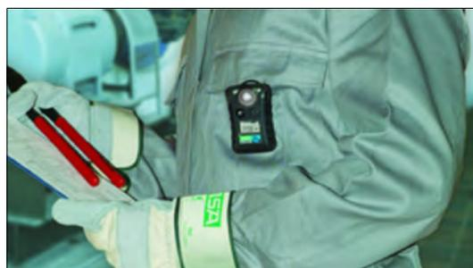
Appareil portatif de mesure de gaz (HCN, Hg)
