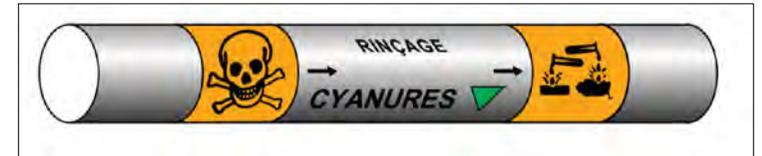
Exemple de marquage d'identification de canalisation contenant du cyanure en solution
