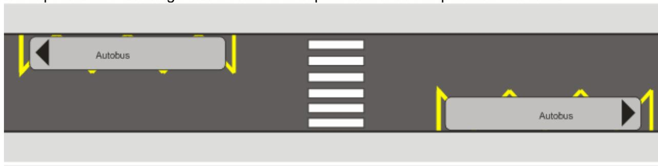
Le passage piéton doit être placé au minimum à 5 m et au maximum à 10 m derrière l'arrêt. En effet, cela permet de conserver une distance acceptable entre le point d'arrêt et la traversée piétonne, et ainsi éviter que le piéton coupe la chaussée hors du passage matérialisé.
