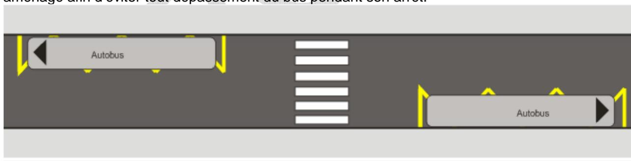
Le passage piéton doit être placé au minimum à 5 m et au maximum à 10 m derrière l'arrêt. En effet, cela permet de conserver une distance acceptable entre le point d'arrêt et la traversée piétonne, et ainsi éviter que le piéton coupe la chaussée hors du passage matérialisé.
