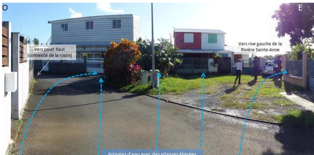
Figure 4 : Conditions d'écoulement des eaux en aval de la voie descendante du lotissement Eglise2
