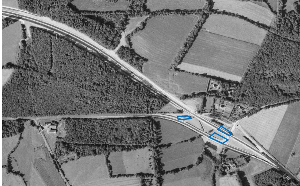
Figure 15 : Remblais réalisés en 1993 lors de la réalisation de la RN164. La zone humide actuelle est figurée en bleu
