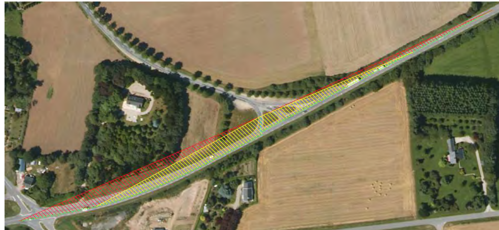
Visibilités à gauche et à droite depuis l'îlot Ouest
