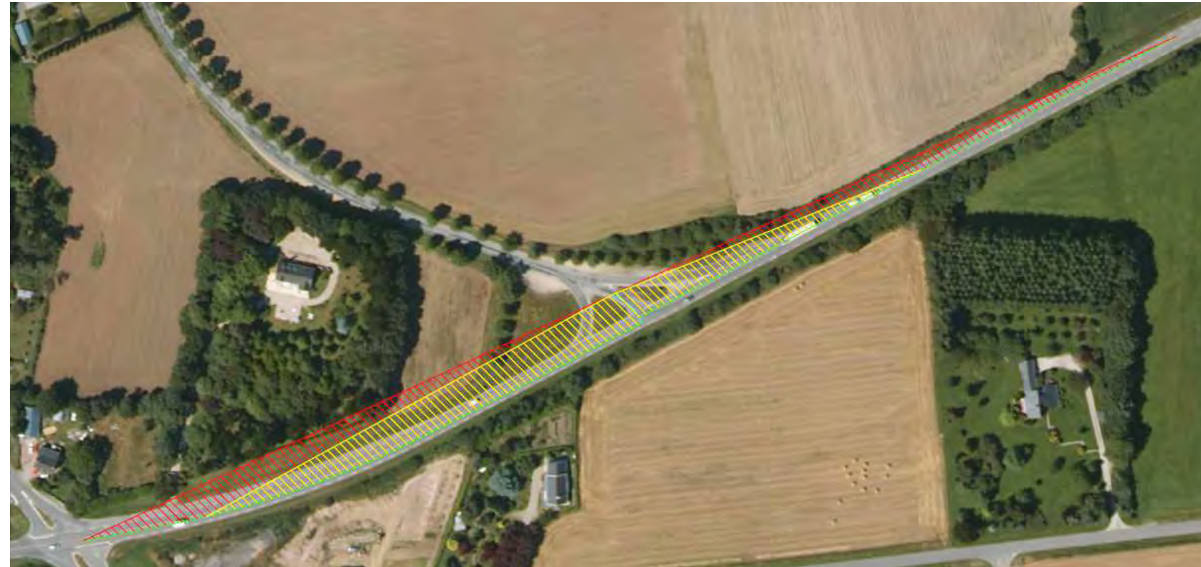
Visibilités à gauche et à droite depuis l'îlot Est
