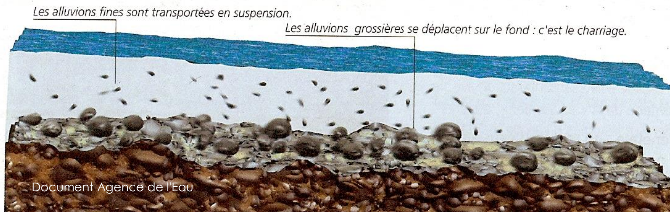
Figure 59 : Différents types de transport solide en dehors des laves torrentielles.
