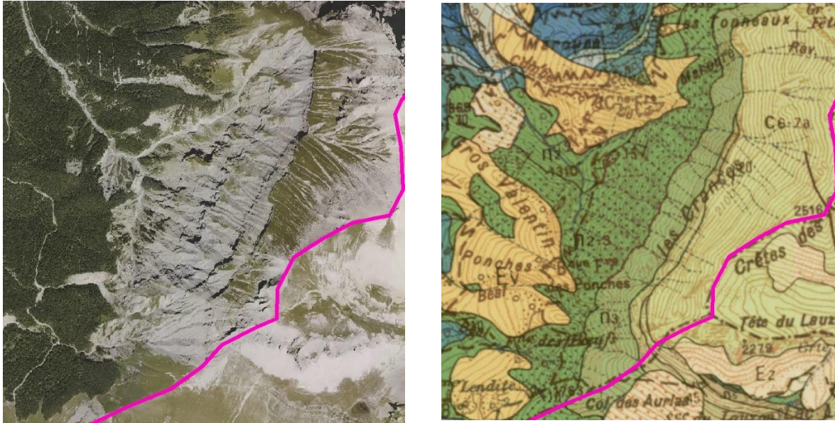
Figure 7 : zone d'érosion active au sein des calcaires grés-argileux du Valanginien (n2-3 en vert foncé), bassin du torrent du Sauvey.
