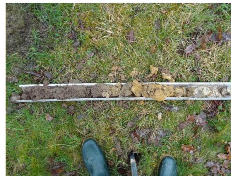
Figure 2 – Sondage à la tarière manuelle avec 3 horizons visibles et distincts (non humide en noir, rédoxique en orange et réductique en gris) – © EGIS
