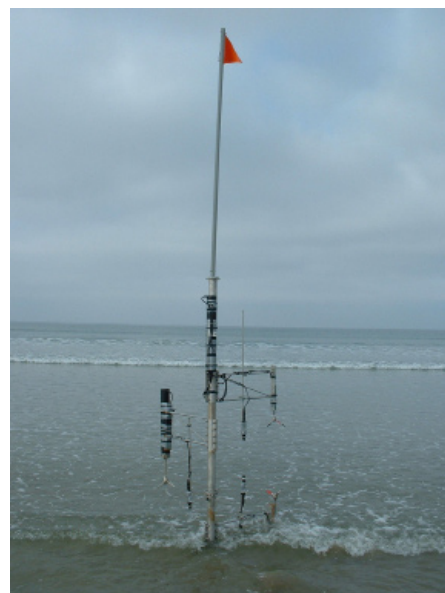
Figure 1. Mât instrumenté intertidal MI2 sur la plage de Pentrez en baie de Douarnenez (Finistère).
