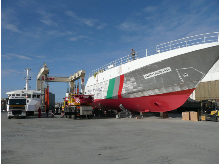
Samba Laobé Fall, baliseur du Sénégal, en cours de construction
