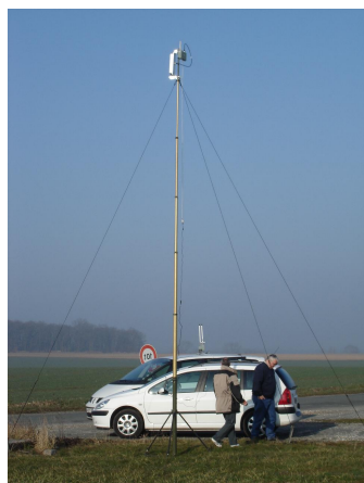
Relais installé sur mat télescopique de 7 m
