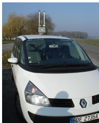
Relais mobile couplé à un système de mesure de débit de transmissions
