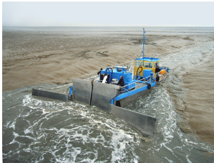
les «cinq abbés» bateau désenvaseur spécialisé dans le curage des canaux
