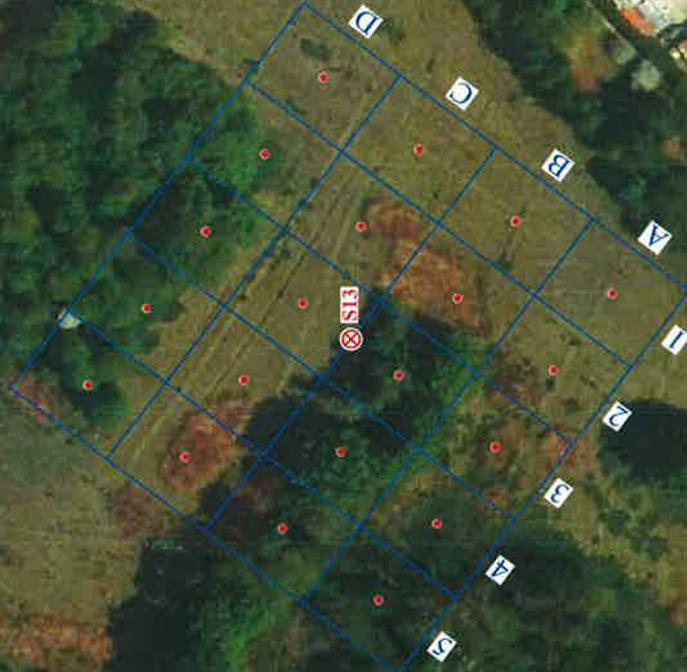
• Prélèvements d'échantillons unitaires de sols superficiels pour la confection d'un échantillon composite
