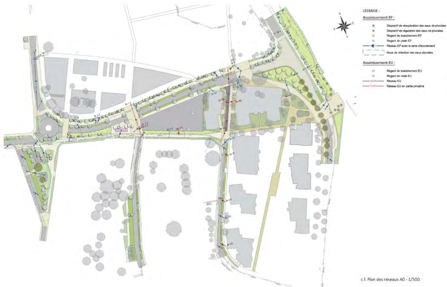
Figure 24 : Plan du réseau d'assainissement des eaux pluviales (Source : Phytolab et Artélia, Juin 2021)
