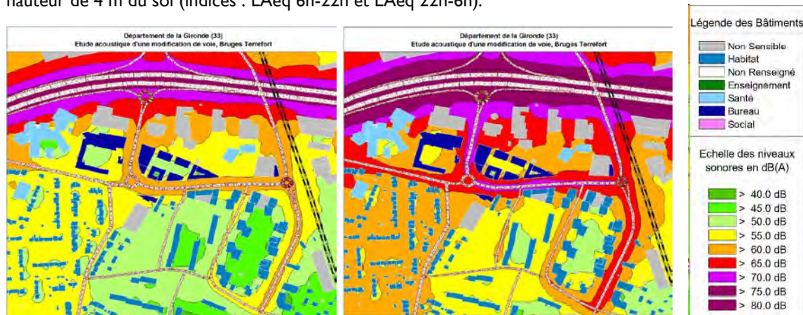
Figure 12 : Cartographie sonore de l'état projeté pour la période 6h-22h (à gauche) et 22h-6h (à droite) à 4m du sol
