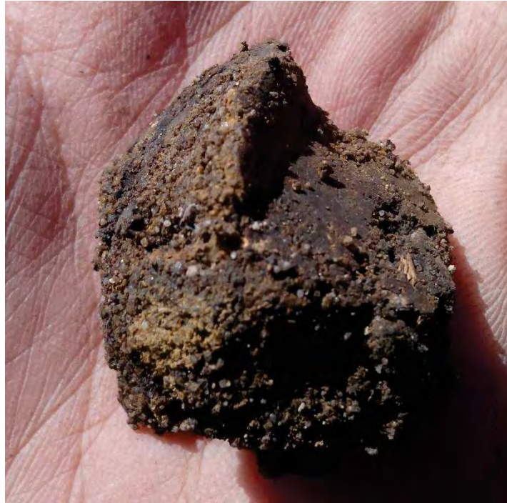
Photo 28 : Sondage N° 1386, texture argilo-sableuse compacte avec présence de grains calcaires et observation de traces d'hydromorphie
