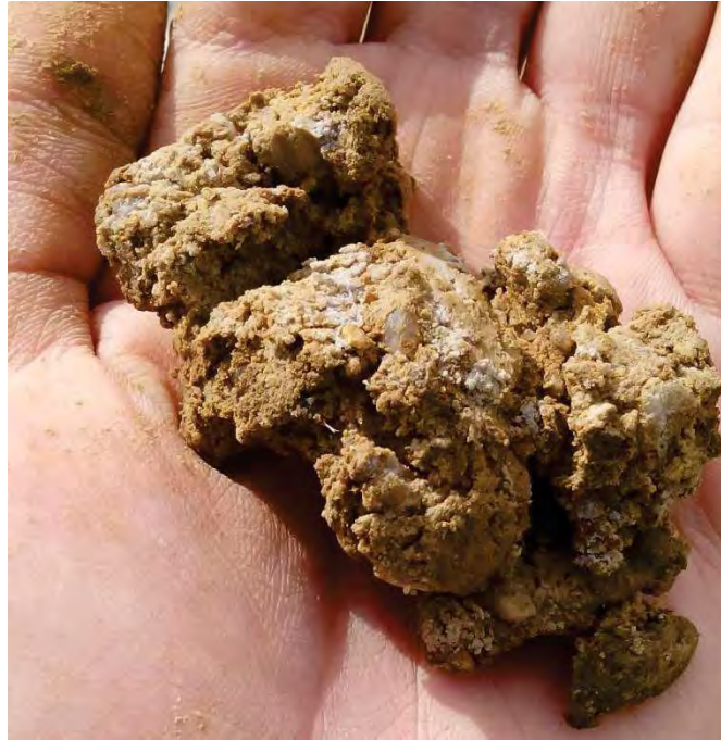
Photo 10 : Sondage T3, texture argileuse avec grains calcaires
