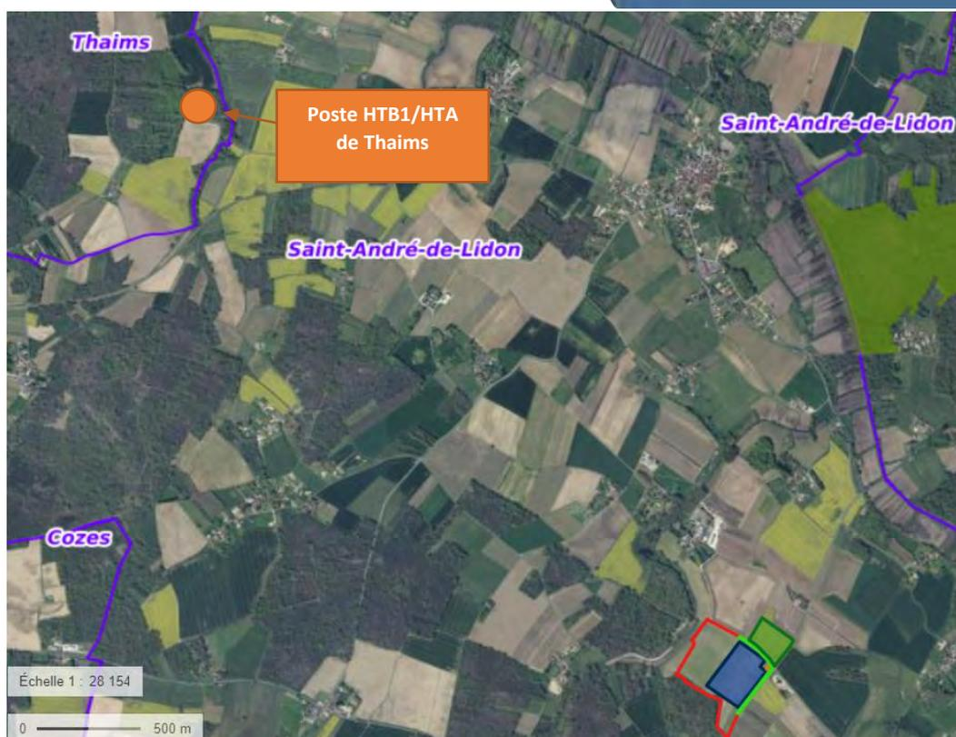
Figure 8 : plan prévisionnel de raccordement
