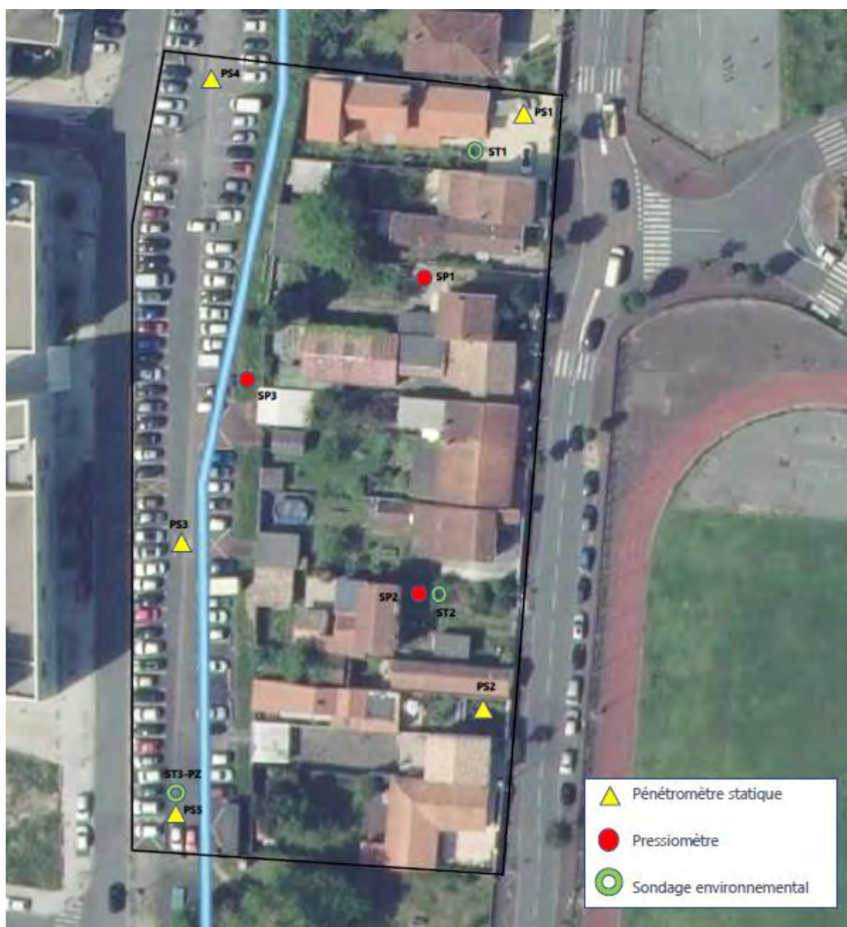
Figure 10 : Localisation des sondages réalisés par ESIRIS Ingénierie
