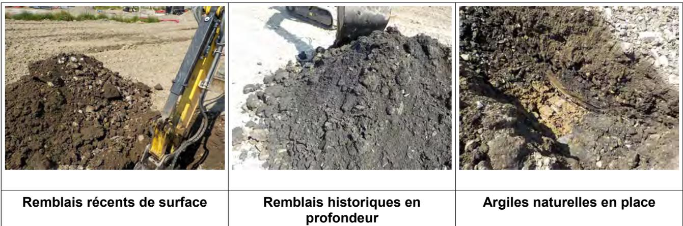
Les sondages réalisés ont atteint une profondeur maximale de 2 m avec atteinte systématique des terres naturelles en place.
