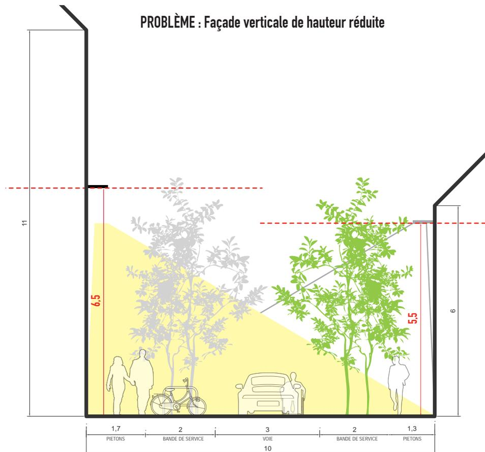
SOLUTION : Réduction de la hauteur d'implantation de l'appique sur le côté concerné et ajustement de l'interdistance en conséquence sur la rue ou zone entière.
