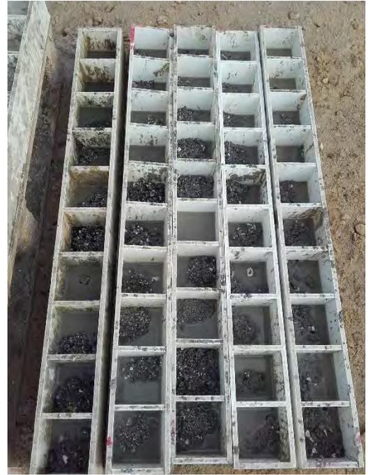
Echantillon mètre par mètre de 36 à 180 m
