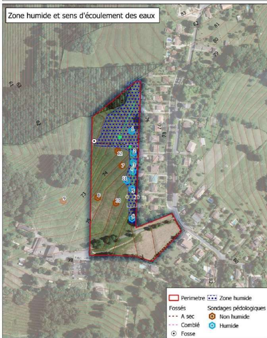
Projet de Collège sur la commune de Fargues St Hilaire - Délimitation de la zone humide sous critère pédologique
