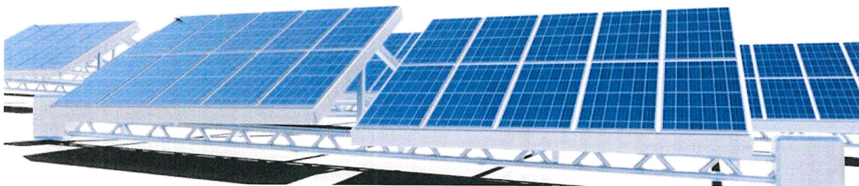
Figure 2 Modélisation 3D de l'ombrière (ATER Environnement – réserve de Tusson demande de PC)
