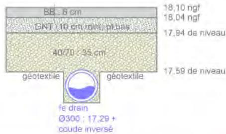
Figure 10 : Coupe technique prévisionnelle de l'ouvrage de rétention (DAREMA Topo – EDANLO)
