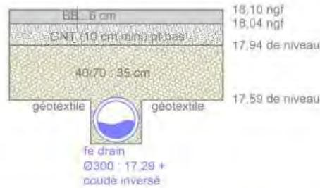
Figure 10 : Coupe technique prévisionnelle de l'ouvrage de rétention (DAREMA Topo – EDANLO)
