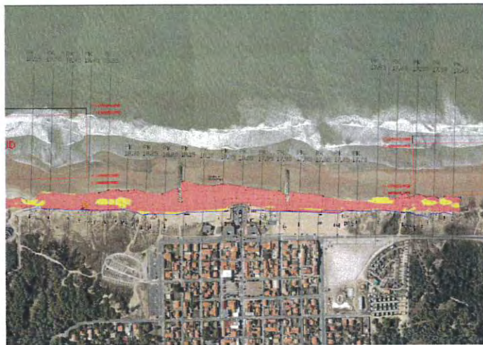
Figure 18 : Exemple des travaux de rechargement de plage printanier du 11/05/2020 et 05/06/2020. Source : Fiche travaux CDC MA
