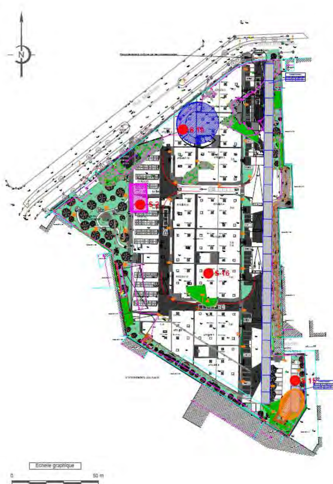
Localisation des zones polluées sur la plan de masse du projet Source : SIT&A
