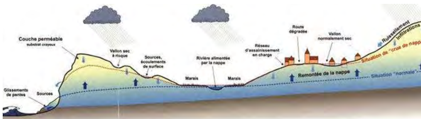
Figure 2 : coupe de principe de fonctionnement des nappes superficielles (B.R.G.M.)
