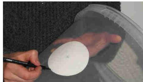
Il n'est pas possible de découper les ouvertures au cutter. Il faut se munir d'un fer à souder (ou d'un pyrograveur) ou d'une scie sauteuse. A la combustion, une des caractéristiques du PP et du PE est de ne pas fumer autant que le PVC, et de sentir la cire. Opérer tout de même dans un local aéré.
