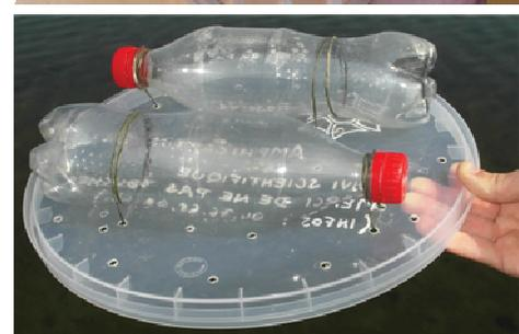
Pour une bonne étanchéité, les bouchons peuvent être encollés avant vissage.
