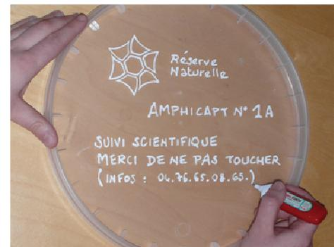
Les flotteurs de l'Amphicapt sont placés sous le couvercle pour gagner en encombrement. Il faut en placer 2 tête-bêche pour équilibrer la flottaison.
