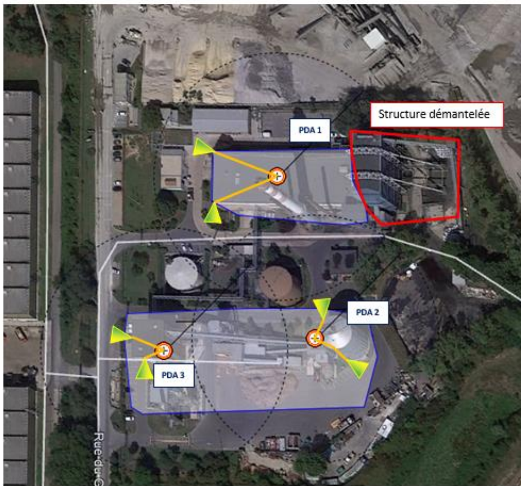
Implantation des paratonnerre, conducteurs de descente et prises de terre
