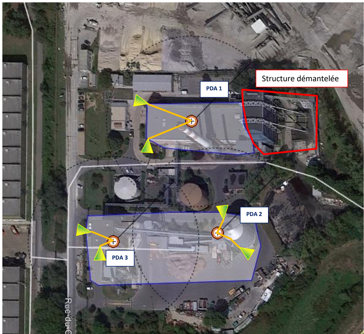
Implantation des paratonnerre, conducteurs de descente et prises de terre
