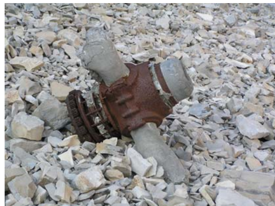
Moteur, hélice tripale sectionnée
