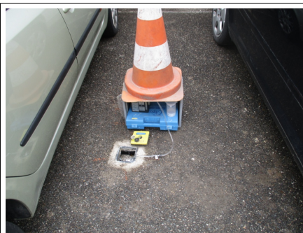
Ouvrage PzrA1 pendant le pompage pour prélèvement
