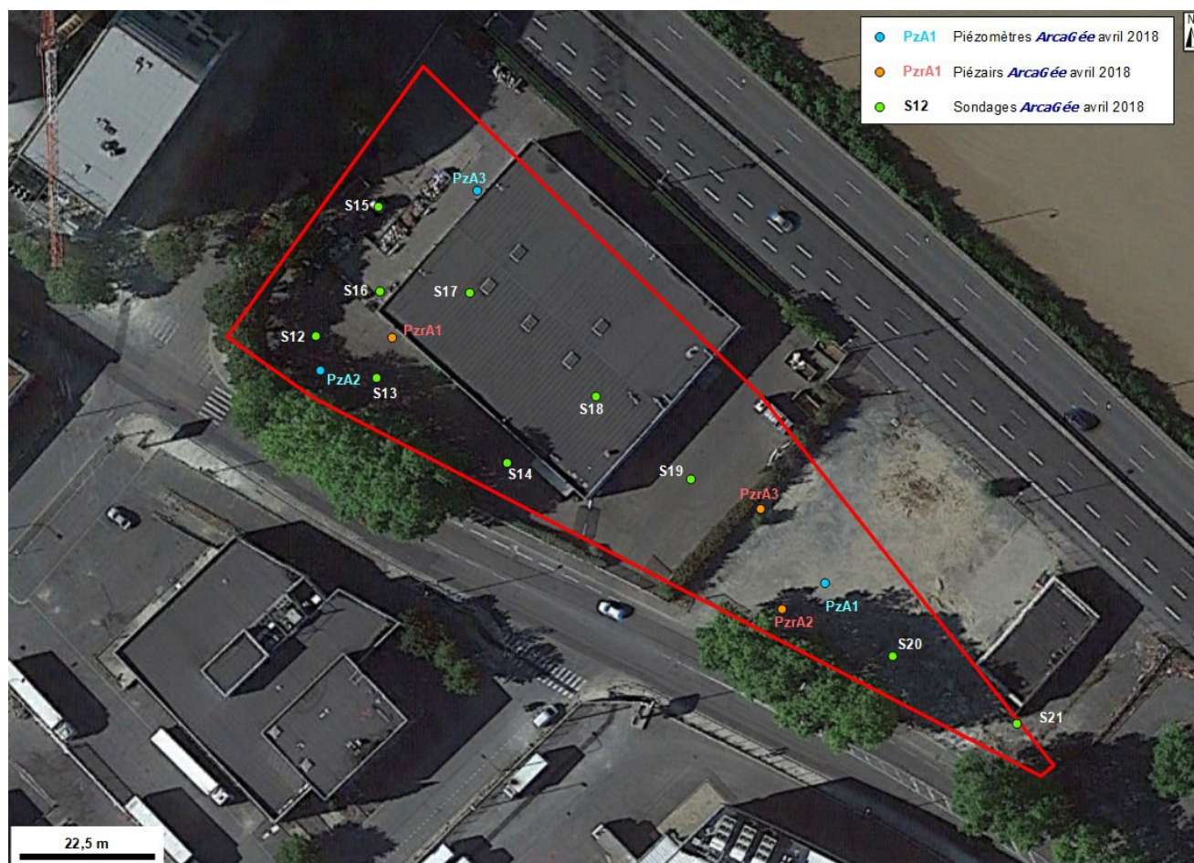
Localisation des sondages (piézomètres et piézairs) réalisés
