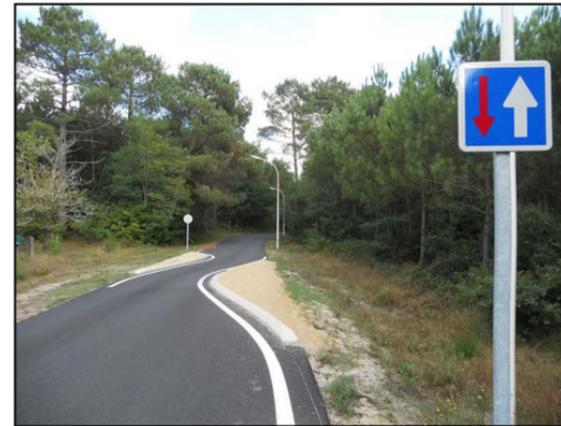
Exemple de voie en « espace partagé » entre véhicules motorisés et cycles, avec aménagements de réduction de vitesse (ici chicanes)
