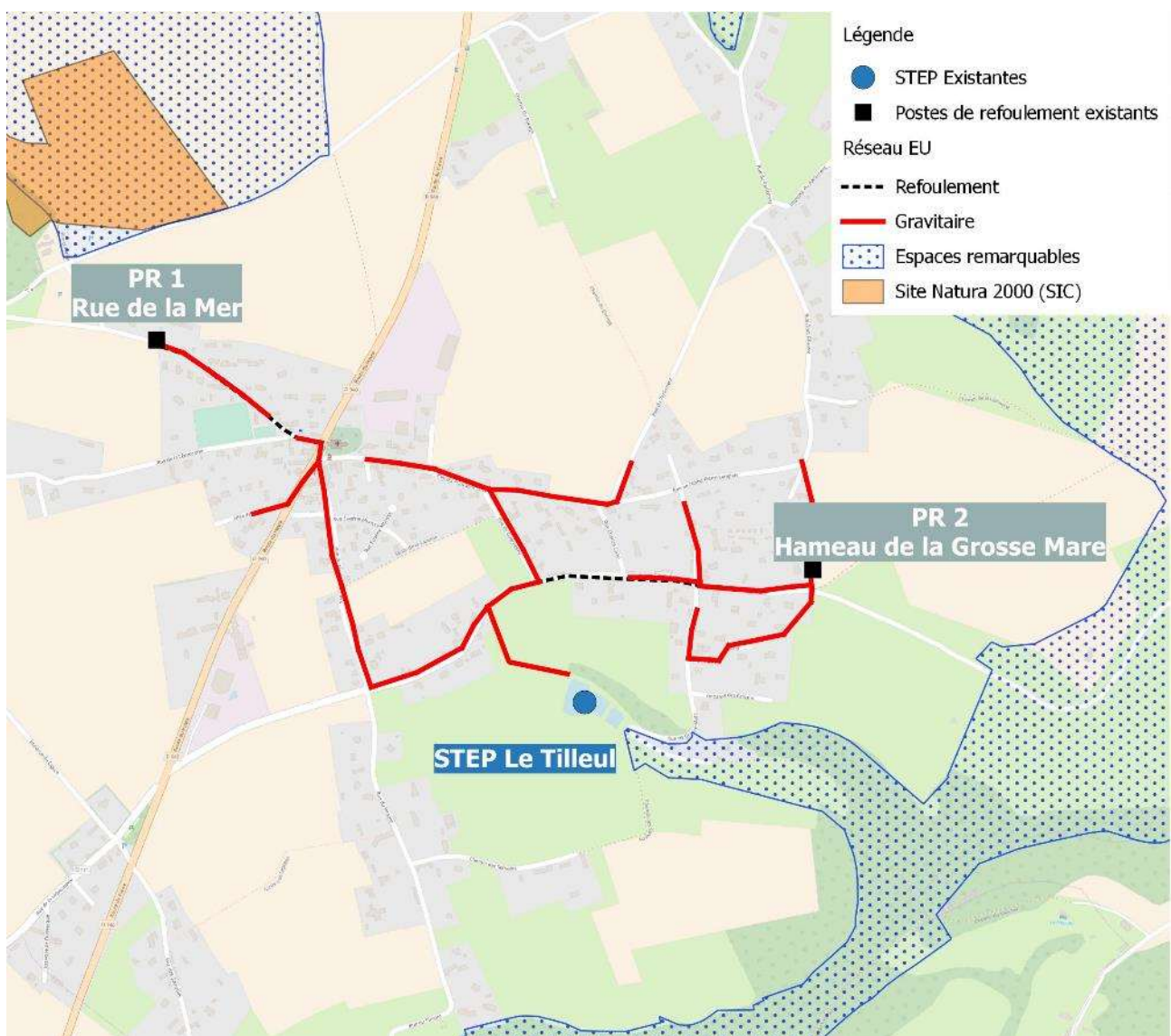
Figure 8 : Réseau d'assainissement actuel du Tilleul
