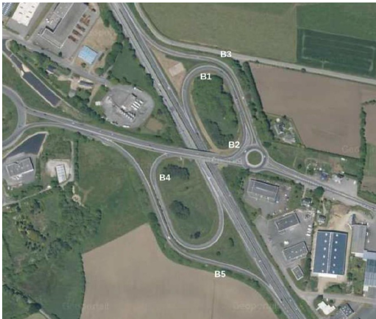
Figure 2 : Identification des ouvrages et des bretelles- Echelle 1/6 000
