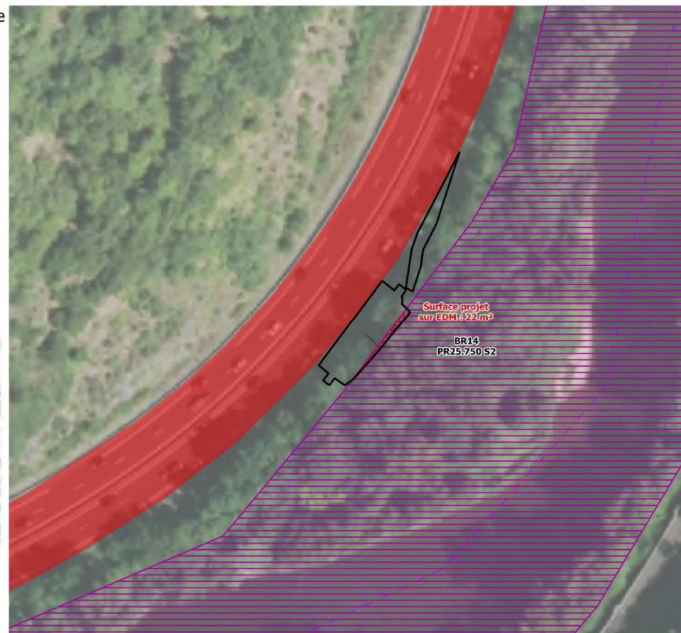
Illustration 10 : PPRI par débordement de l'Allier (crue trentennale) et emprise travaux au niveau du refuge PR23.900
