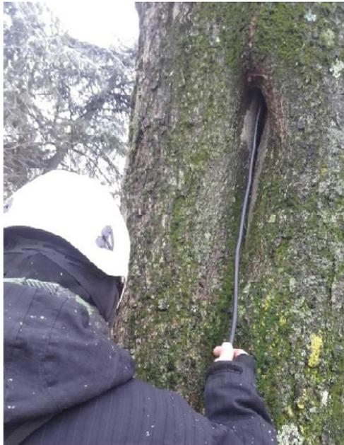
Contrôle d'une cavité à l'aide d'un endoscope (Hors site – Ecosphère)
