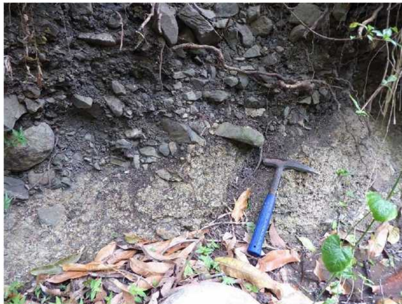
ILLUSTRATION 6 : FOND DE LA RAVINE INDURE SURMONTE DE PLUSIEURS METRES DE COLLUVIONS
